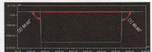
溝加工における溝壁面倒れ測定
